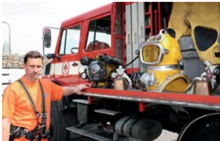
Četař potápěčů HBZS Radim Kocián předvádí těžký skafandr pro práci ve velkých hloubkách a podvodní kameru pro vyhledávání osob a předmětů a záznam akcí záchranářů pod vodou.
